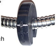
14. Etwa an der Stelle, an der der nun fast gestreckte Brauseschlauch (1) in das Einfüllrohr übergeht, muss der Zugstopper montiert werden. Dazu hältst Du den Brauseschlauch (1) an der ermittelten Stelle fest, ziehst ihn heraus und setzt den Zugstopper (6) an. Mit etwas Kraft drückst Du den Brauseschlauch (1) in die Kerbe des Zugstoppers (6), bis der Brauseschlauch (1) in der Mitte des Zugstoppers (6) sitzt und der Zugstopper einrastet und nur mit viel Kraft noch verschiebbar wäre.
