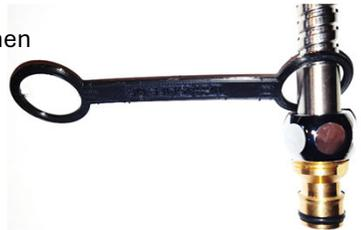
18. Je nachdem, ob der größere Ring des Zugbands (4) nun über das Innenstück des Tankdeckels passt oder nicht, kannst Du den Ring entweder über das Innenstück ziehen oder aber Du biegest es vor dem Schließen des Tankdeckels nach innen. **Fertig.**
